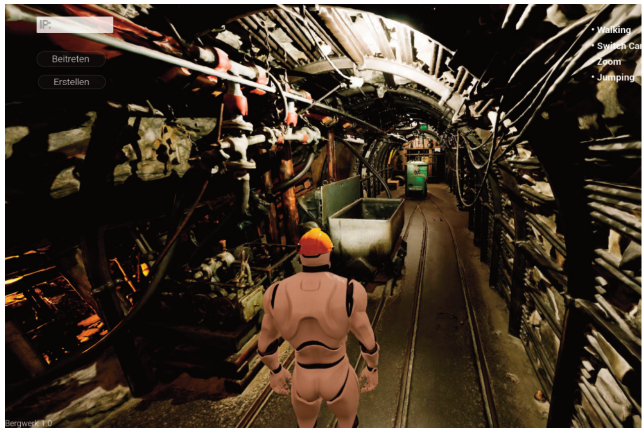
Abb. 5: Visuelle Kontrolle des 3D-Modells mittels Gaming-Software
