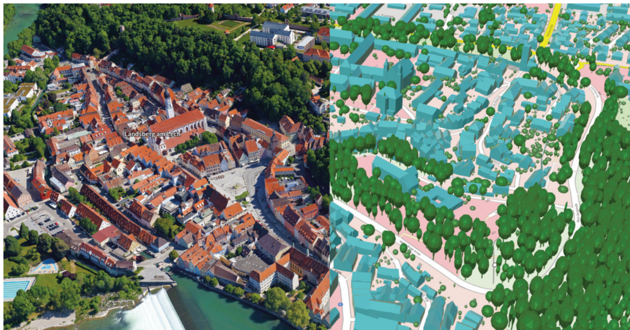
Abb. 2: Ausschnitt aus dem TwinCity3D-Client mit dem CityGML-LOD2-Modell auf der rechten und dem kongruenten texturierten Mesh-Modell aus den Befliegungsdaten auf der linken Seite
